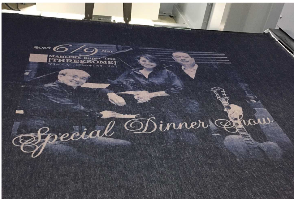
写真 1 2 レーザー光線で作成したジーンズ
